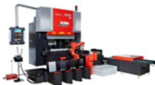
Die Biegezone AMADA EG-6013AR mit Roboter und automatischem Werkzeugwechsler bietet die perfekte Bearbeitung kleiner und komplexer Biegeteile.
