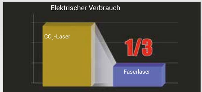
Der Wirkungsgrad des Faserlasers ist 3-fach besser als der eines CO<sub>2</sub>-Lasers. Darüber hinaus ist ein Warm-Up der Strahlquelle nicht notwendig, sie ist umgehend einsatzbereit. Der Energiebedarf ist somit insgesamt deutlich niedriger. Die Betriebskosten fallen im direkten Vergleich bis zu 70 % geringer aus.
