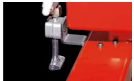
Persluchtstraal om de platen van elkaar te kunnen scheiden
