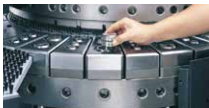
Sneller, gemakkelijker verwisselen van het gereedschap tot in de Z-revolver middels uitwerphulzen
