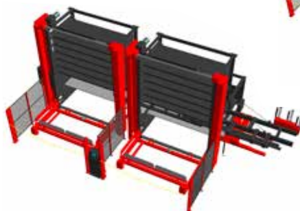
Magazyn paletowy wraz z usuwaniem części
