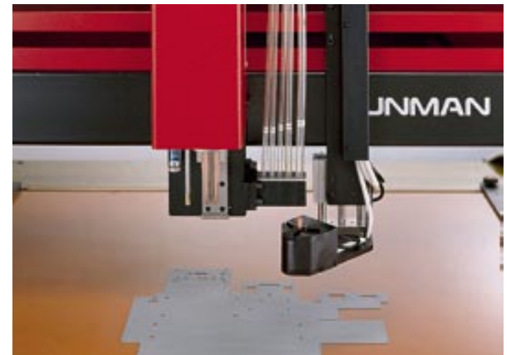
Übergabe des Bolzens durch den Bereitstellungsmanipulator an die Greiferelektrode.
