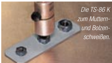
Das Antioxidationssystem verhindert die Verfärbung der Schweißpunkte.
