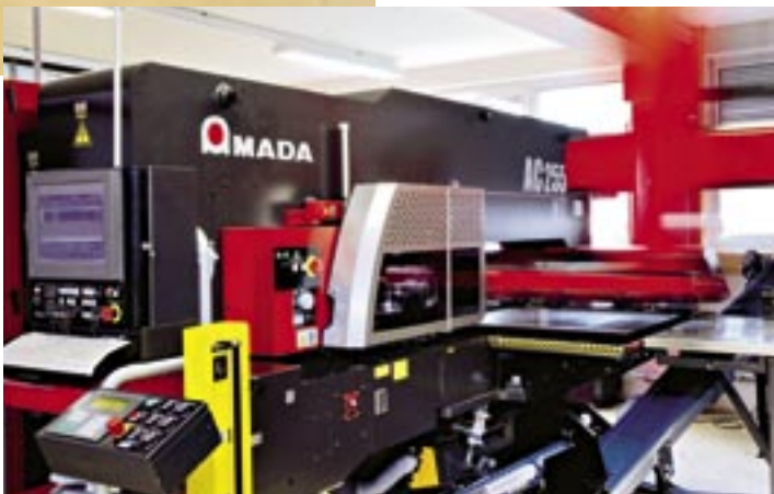
Die AC-255 NT mit ihrem servoelektrischen Antrieb bietet höchste Produktivität bei niedrigen Betriebskosten.
