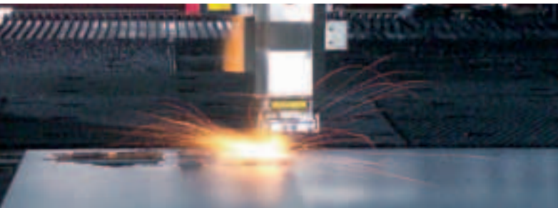
Bei der EML Z-3610 NT dient der Laser als flexibles Werkzeug für komplexe Konturen.
