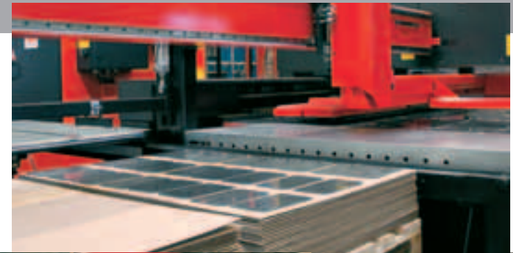
Das automatische Zuführsystem L 300 der LC-2415 Alpha III.
