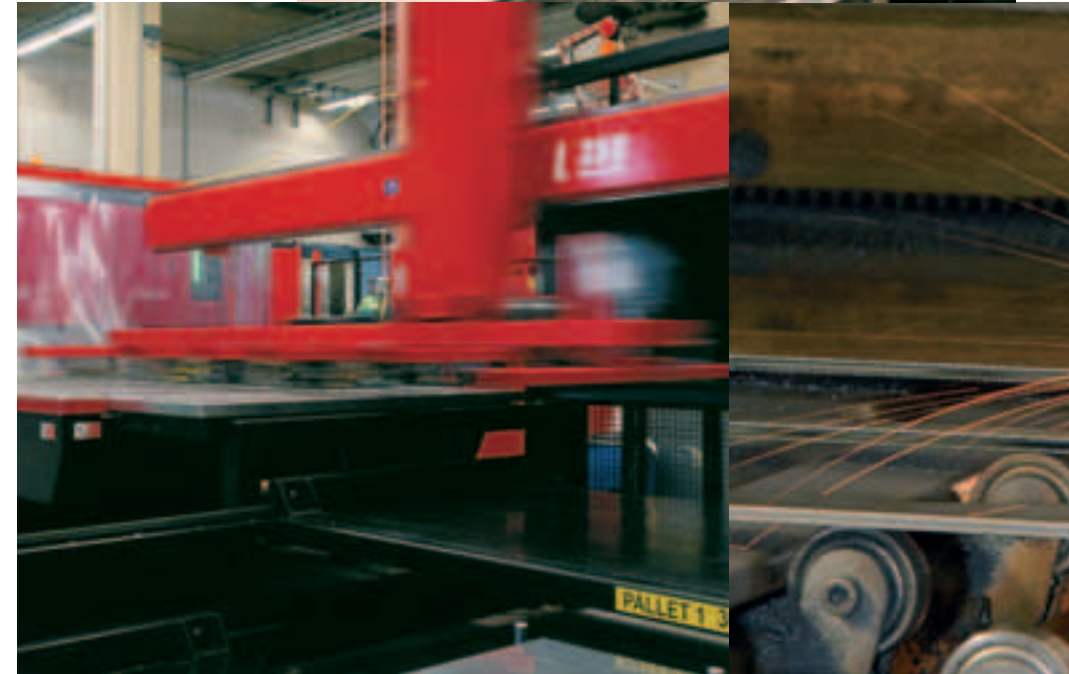
Das automatische Zuführsystem L 300 der LC-2415 Alpha III.
