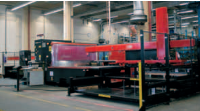
Grillo Peißenberg setzt auf eine vollautomatische Laserschneidmaschine LC-2415 Alpha III von Amada.
