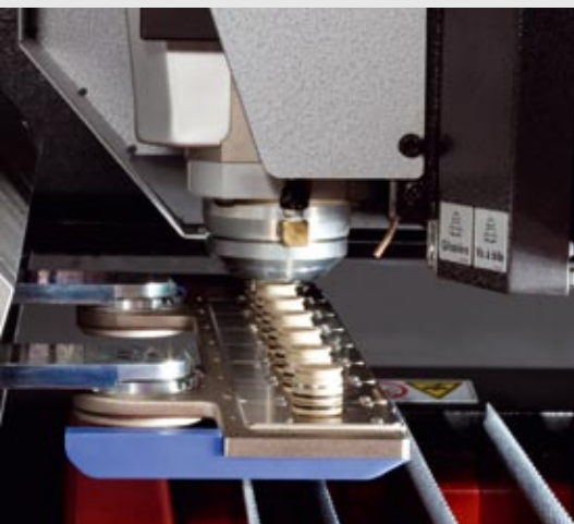
Полностью автоматизированная смена сопел
